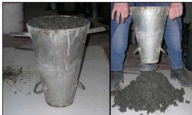
Ilustración 17: Ensayo de Tronco de cono de Abrams invertido para la serie K
