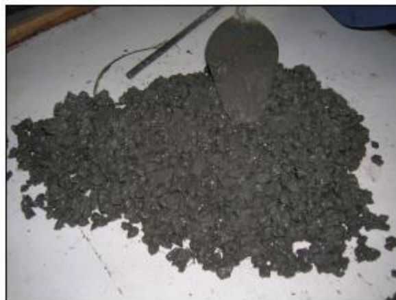
Ilustración 19: Evaluación de posible segregación de pasta en la serie K
