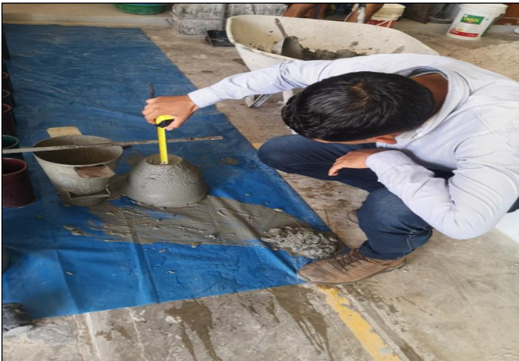
Propiedad del concreto en estado fresco medición del Slump
