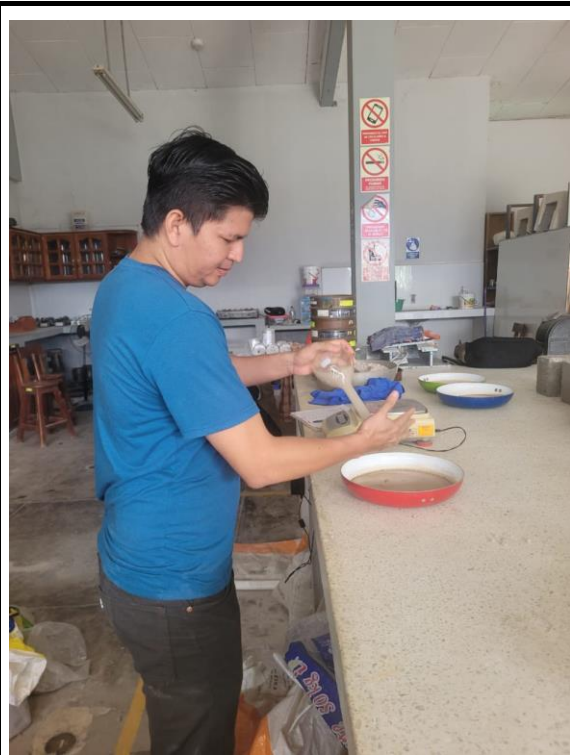
Foto N°5: Vertido de la muestra saturada para su posterior desecación para encontrar el porcentaje de absorción del agregado fino.
