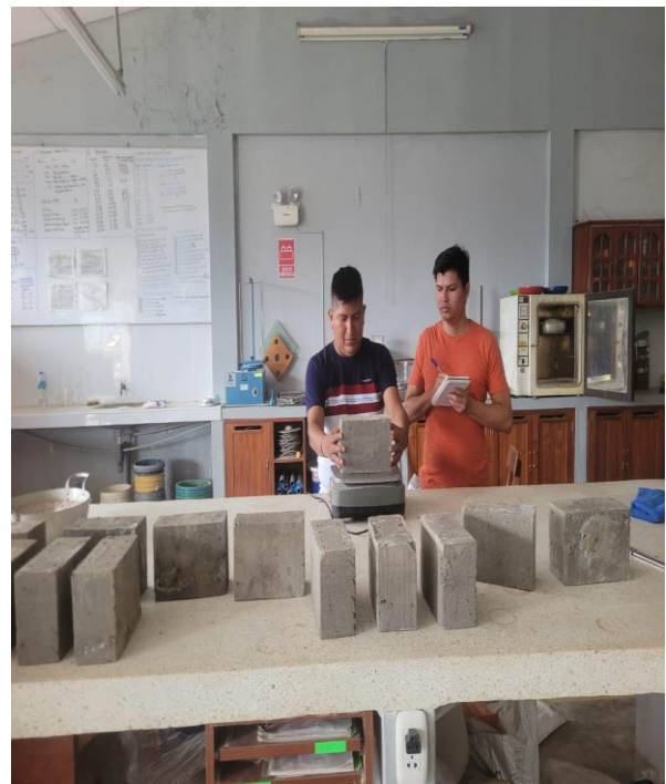
Foto N°34: Determinación del peso para el ensayo de absorción de las unidades de albañilería.
