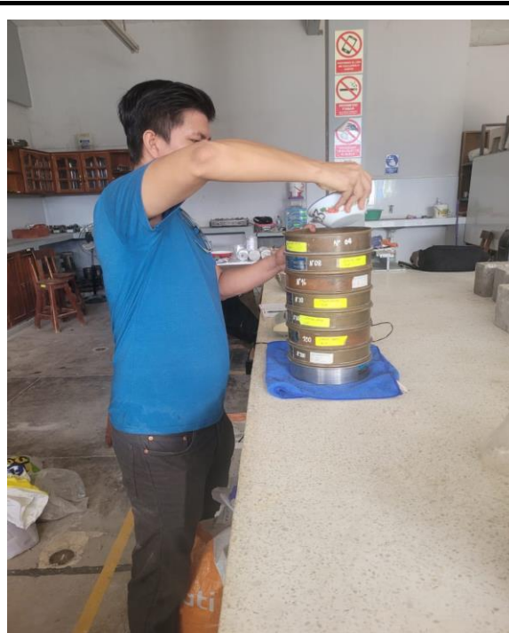
Foto N°8: Ensayo de análisis granulométrico del agregado fino de forma manual.
