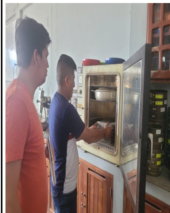
Foto N°35: Secado en horno de las unidades de albañilería, para realizar los ensayos respectivos.
