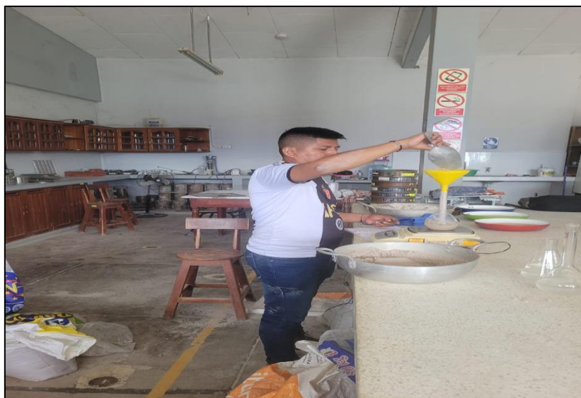
Imagen 7. Pesado de la muestra del agregado fino en picnómetro previamente tarado
