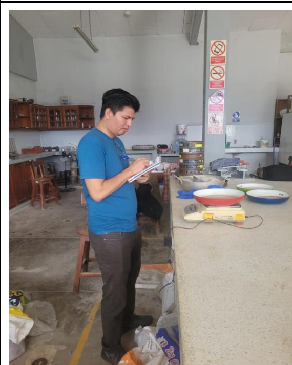
Foto N°5: Vertido de la muestra saturada para su posterior desecación para encontrar el porcentaje de absorción del agregado fino.
