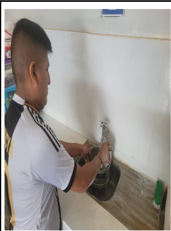
Foto N°14: Proceso del ensayo de determinación de la cantidad de material fino que pasa por el tamiz N° 200.
