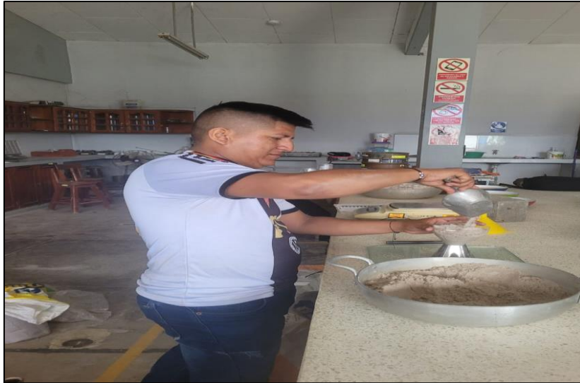
Imagen 5. Verificación de la condición S.S.S., mediante cono Kansas
