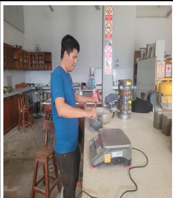
Foto N°12: Proceso de enrasado de la superficie del molde para su posterior pesaje.
