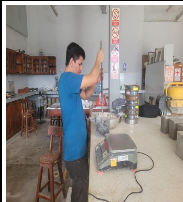
Foto N°11: Varillado del agregado fino para el ensayo de peso unitario seco compactado.
