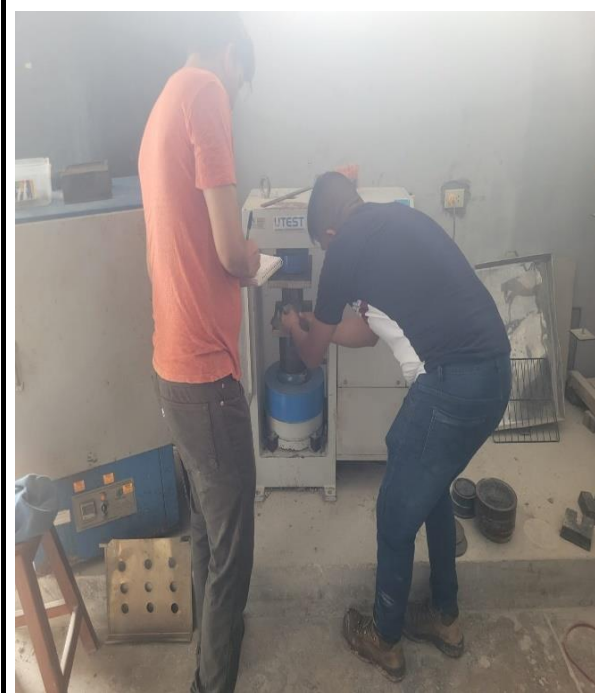
Foto N°39: Prueba de resistencia a la compresión individual de las unidades de albañilería
