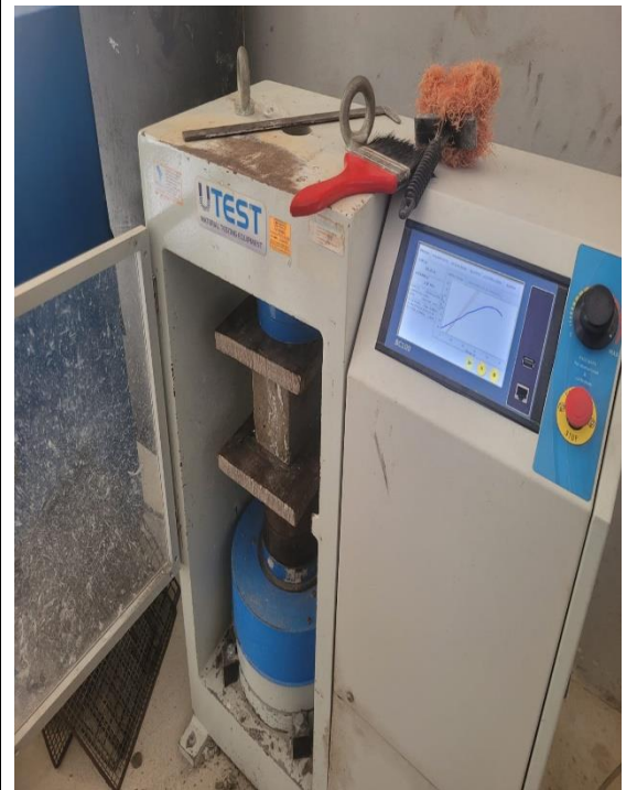
Foto N°38: Prueba de resistencia a la compresión individual de las unidades de albañilería
