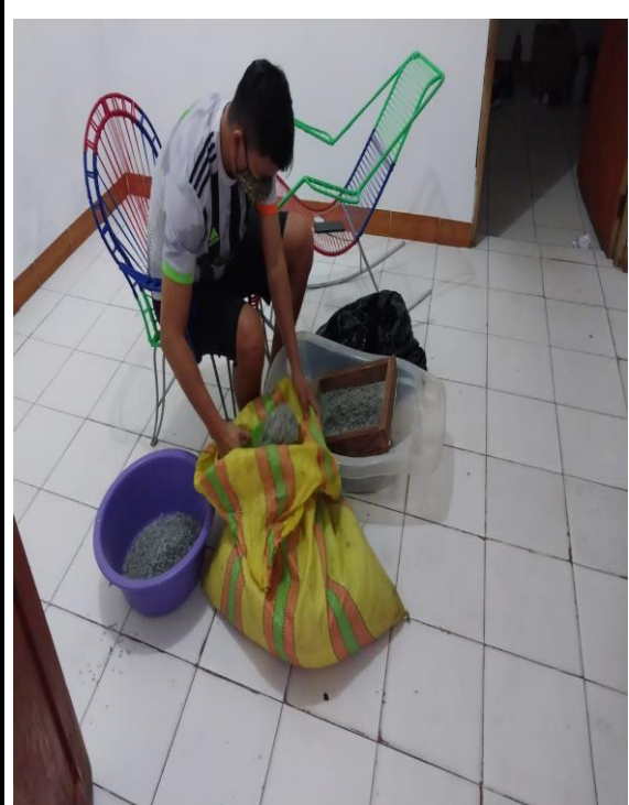
Foto N°16: Tamizado del PET (separado de partículas grandes)
