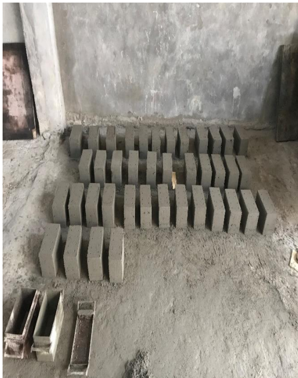
Foto N°27: Unidades de albañilería terminadas
