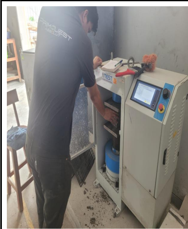
Foto N°37: Prueba de resistencia a la compresión individual de las unidades de albañilería
