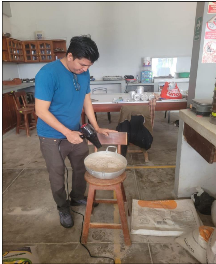
Imagen 4. Deseccación de las partículas del agregado fino.
