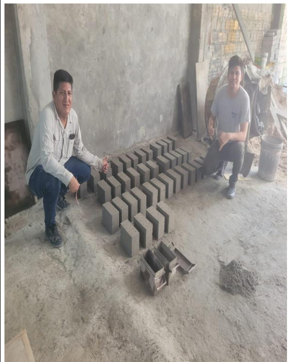
Foto N°28: Unidades de albañilería terminadas
