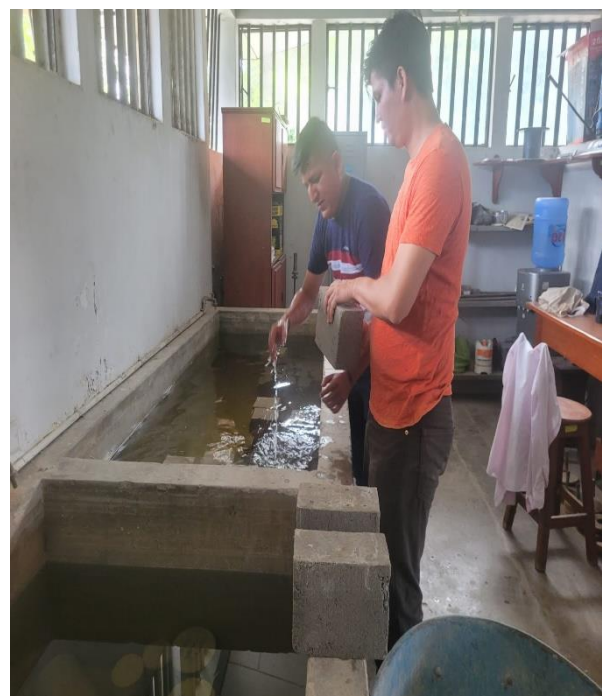
Foto N°36: Saturación de las unidades de albañilería para el ensayo de absorción.
