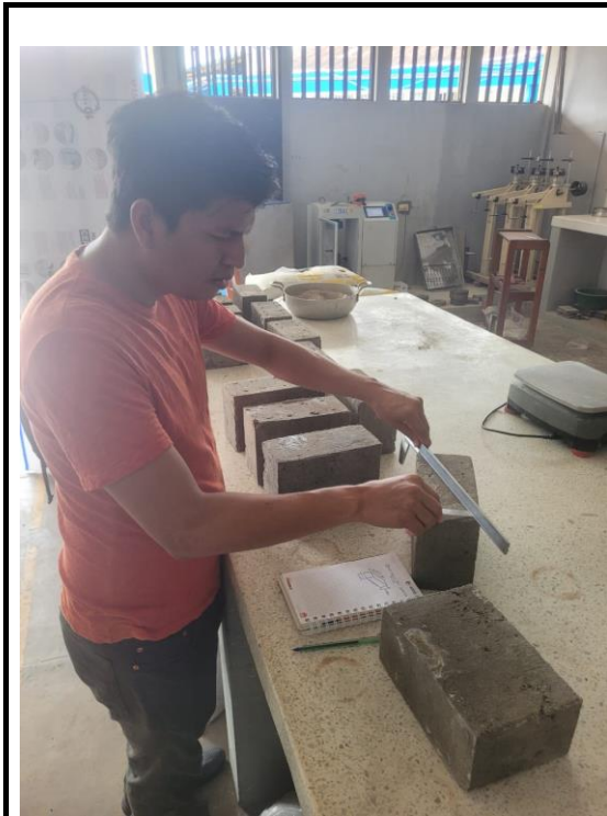
Foto N°33: Proceso de verificación de alabeo en las unidades de albañilería (cóncavo o convexo)
