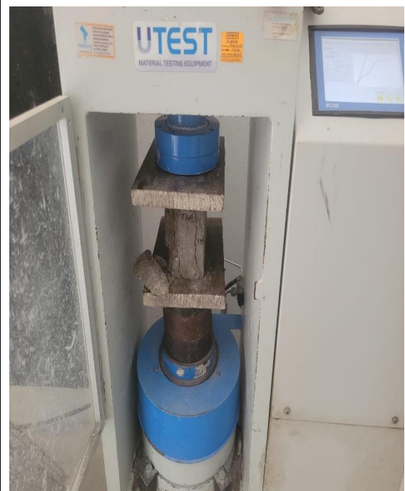
Foto N°40: Prueba de resistencia a la compresión individual de las unidades de albañilería
