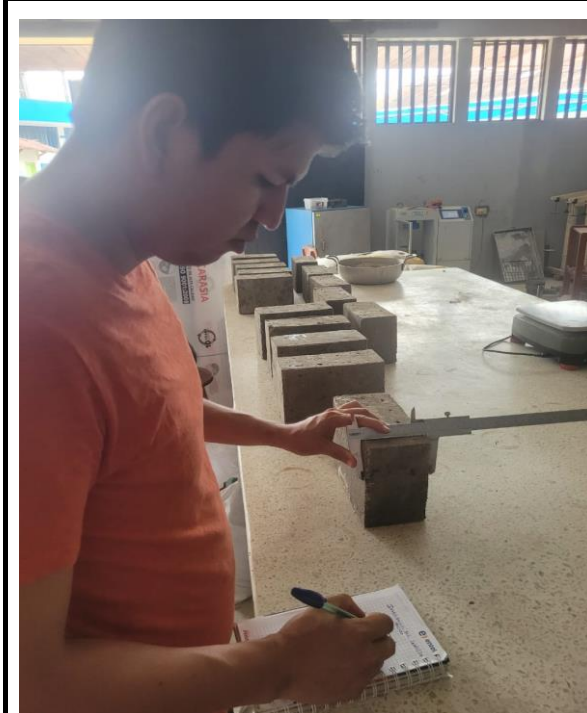
Foto N°31: Registro y medición de las unidades de albañilería para posteriores cálculos (Variación dimensional)
