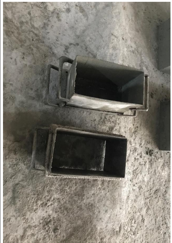
Foto N°20: Moldes para la elaboración de las unidades de albañilería
