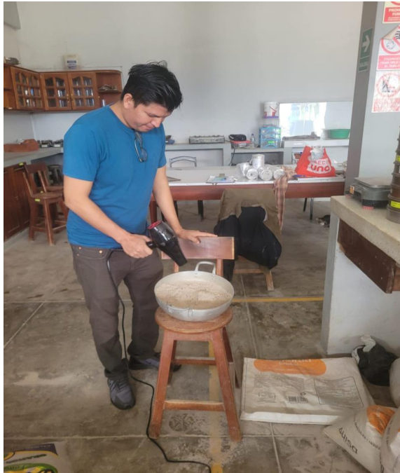
Foto N°1: Dsecación de las superficies de las partículas del agregado fino, para la condición SSS (Saturado superficialmente seco)
