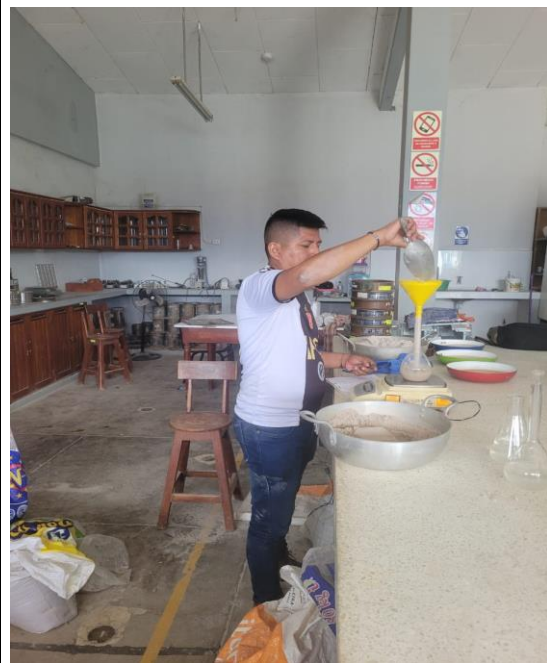
Foto N°4: Pesado de la muestra del agregado fino en picnómetro previamente tarado.
