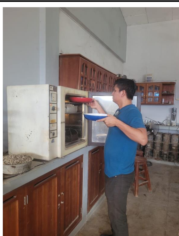
Foto N°6: Secado de la muestra saturada en el horno a 110\text{ }^{\circ}\text{C} \pm 5\text{ }^{\circ}\text{C}
