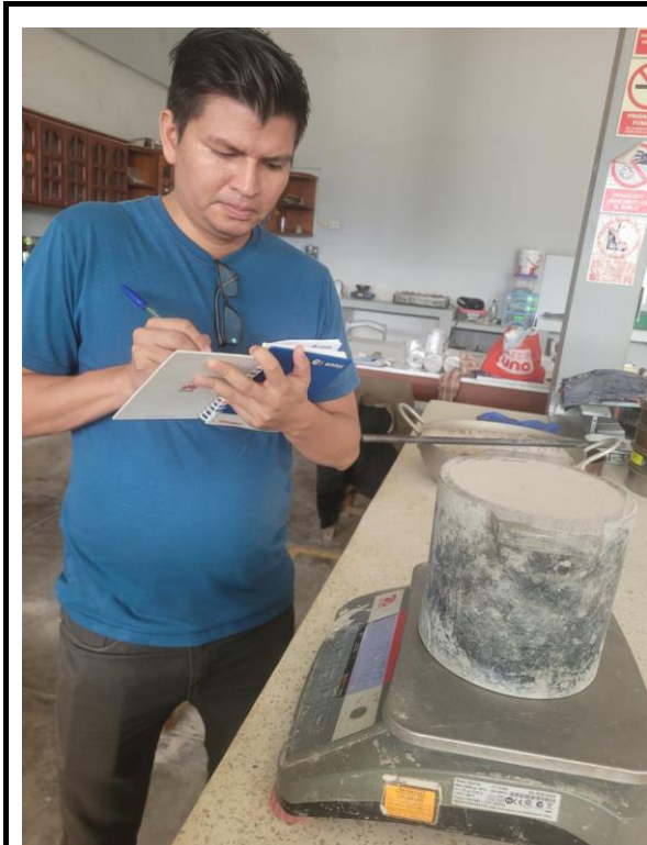
Foto N°13: Anotación y control de pesos para los respectivos cálculos del ensayo de peso unitario seco compactado.
