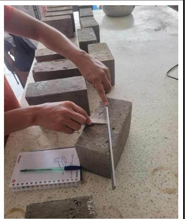
Foto N°30: Registro y medición de las unidades de albañilería para posteriores cálculos (Variación dimensional)
