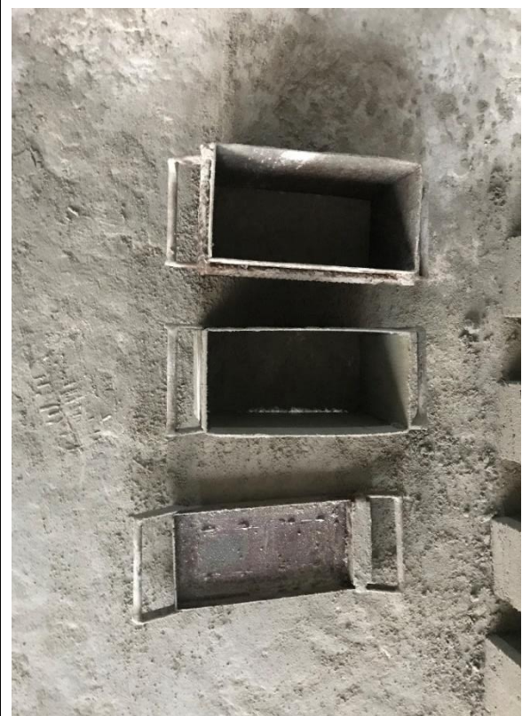
Foto N°19: Moldes para la elaboración de las unidades de albañilería
