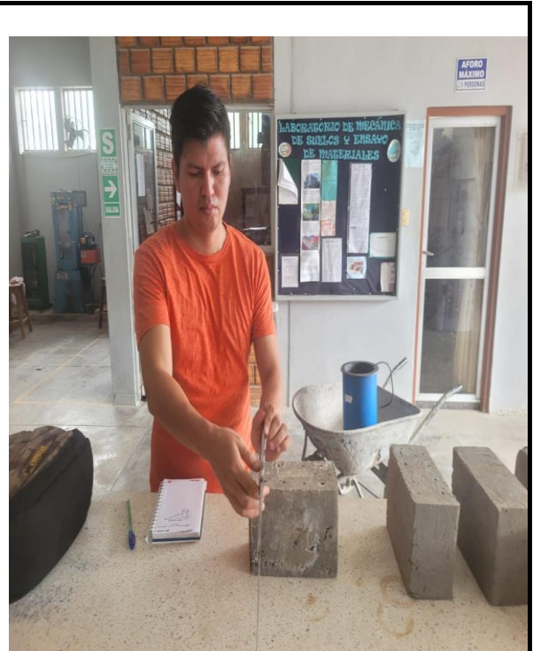
Foto N°30: Registro y medición de las unidades de albañilería para posteriores cálculos (Variación dimensional)
