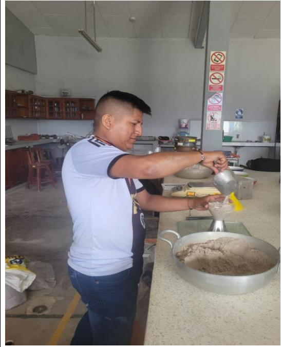
Foto N°2: Verificación de la condición S.S.S., mediante el cono Kansas.
