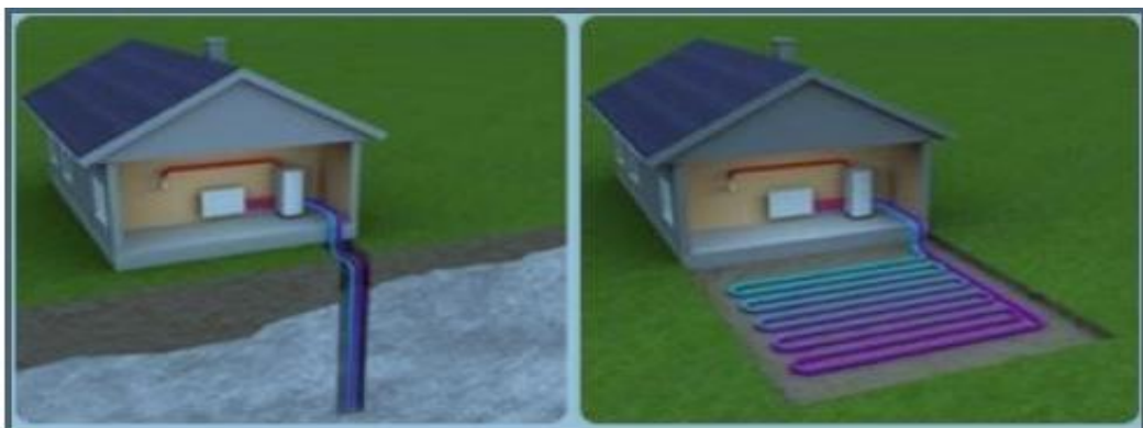
Figura N°19: A la izquierda, método de captación vertical, a la derecha, captación horizontal
