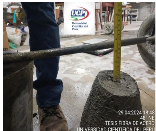
Prueba de slump
