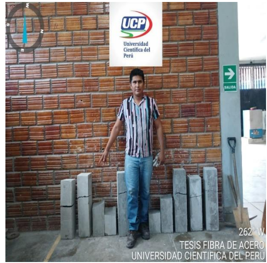
Rotura de vigas con y sin fibra
