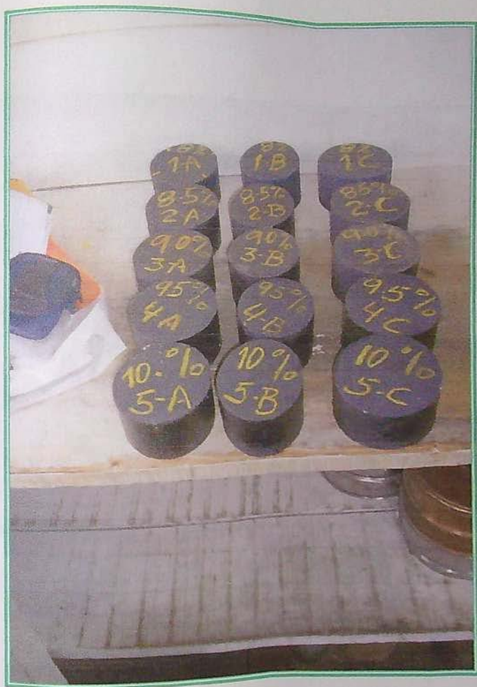
Foto N° 07.- Se aprecia las 15 muestras de asfalto con arena, compactadas y parafinadas
