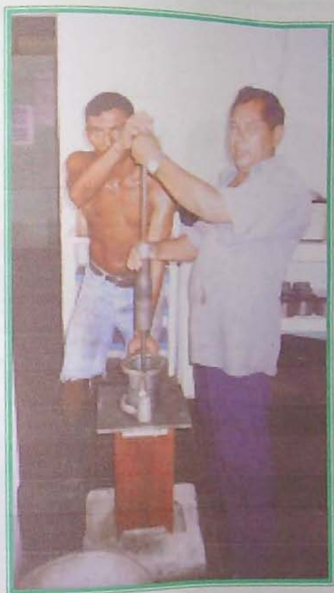
Foto N° 06.- Compactación de la mezcla asfáltica utilizando un martillo de compactación
