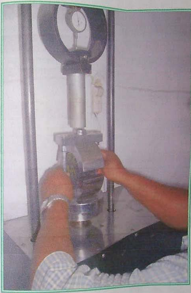
Foto N° 13.- Muestra y mordaza colocada en la prensa marshall.
