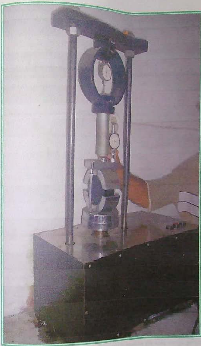
Foto N° 14.- Prensa Marshal, para evaluar la estabilidad y fluencia de la mezcla asfáltica.
