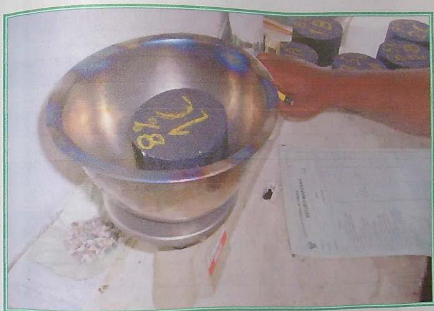
Foto N° 08.- Peso de la briqueta mas parafina compactada en el aire.
