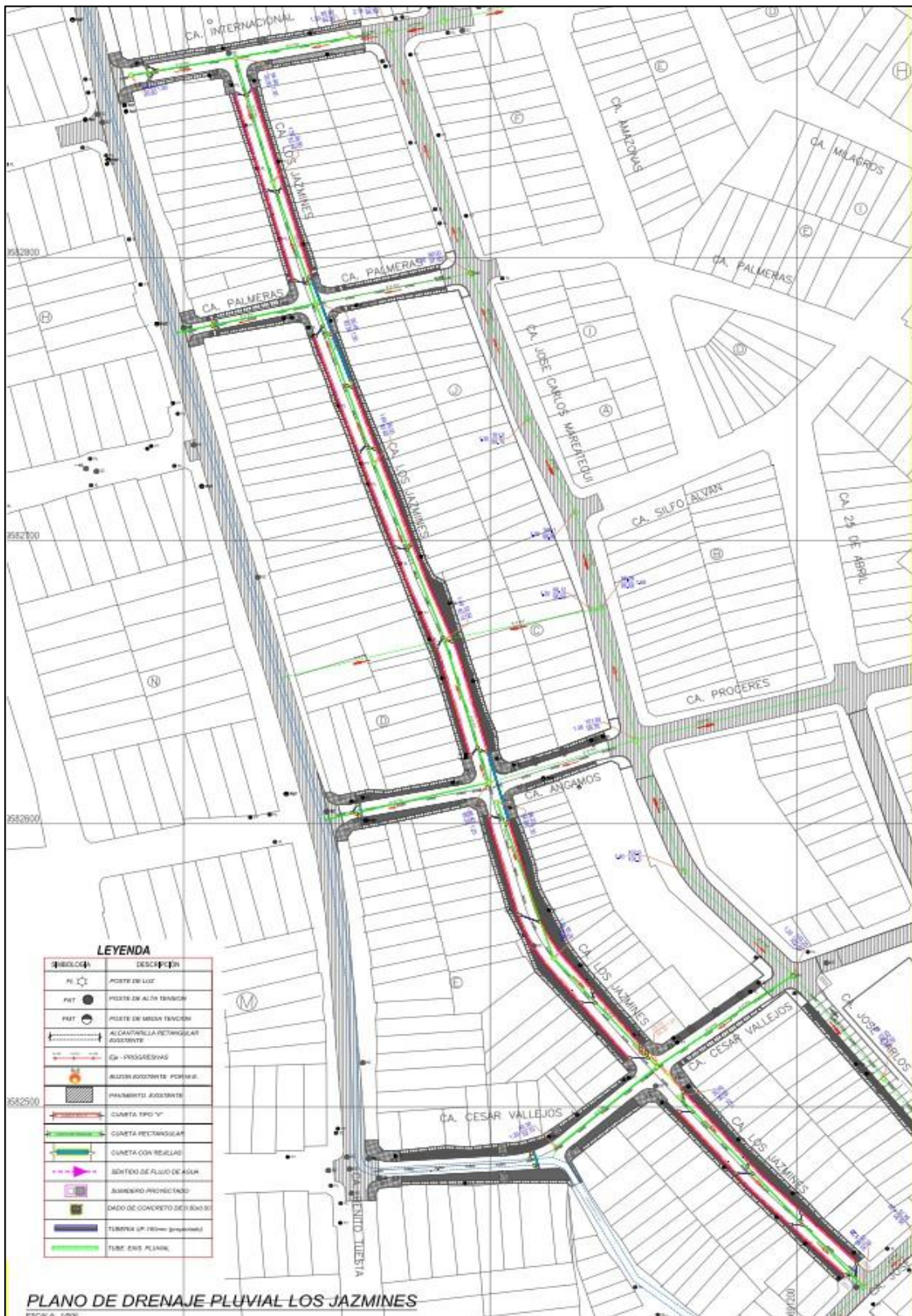
Figura 12: Plano de Drenaje pluvial Los Jazmines
