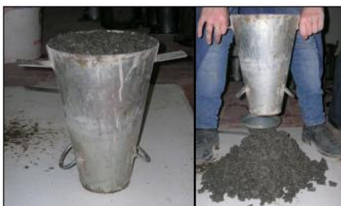
Ilustración 4: Ensayo de Tronco de cono de Abrams invertido para la serie K
