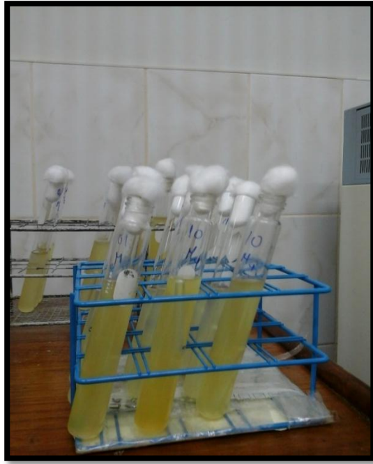
Figura N° 19. Tubo positivo (Presencia de gas). Fase Presuntiva
