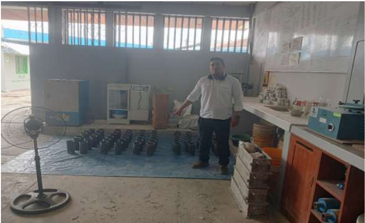
Distribución de moldes para vaciado de probetas.
