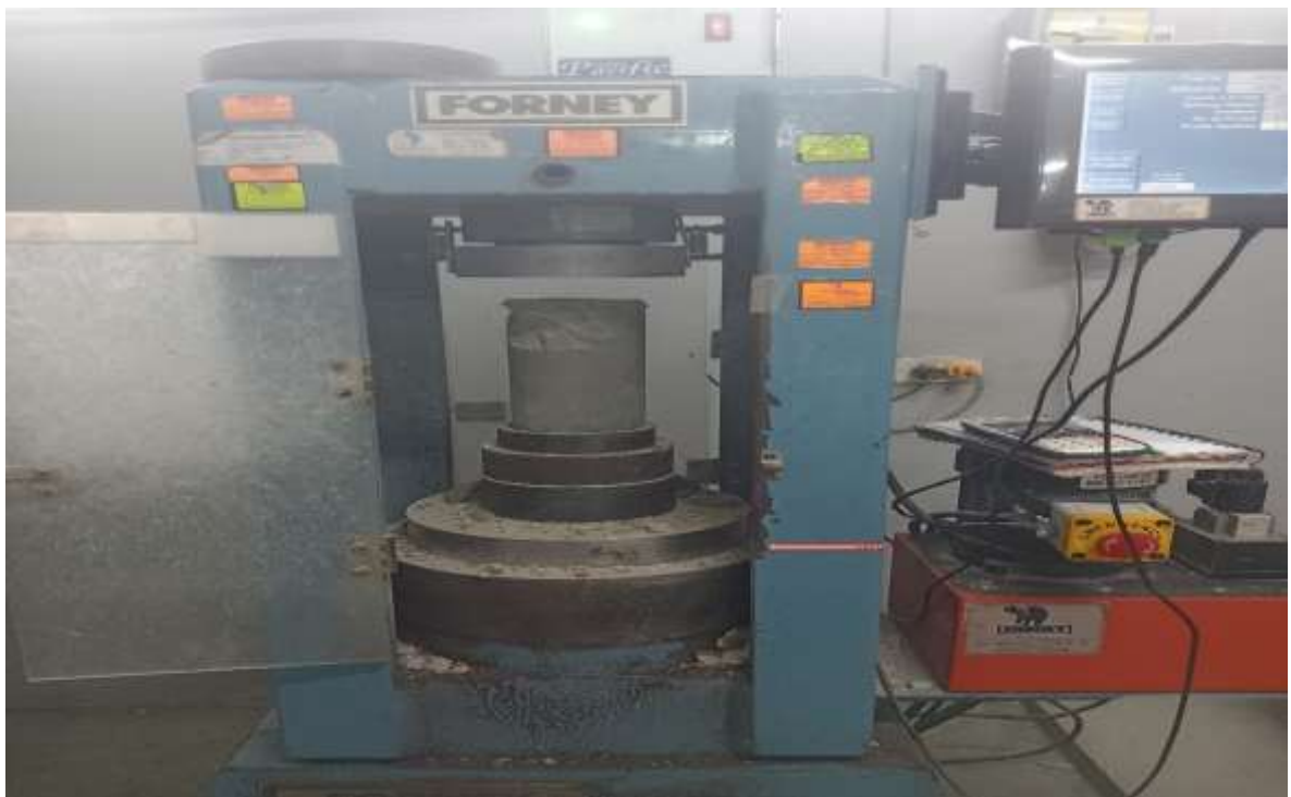
Ensayo de rotura de probetas a compresión a edades de 3, 7 y 28 días.
