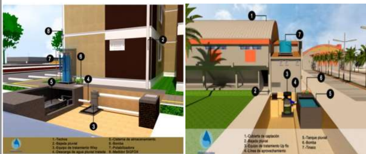
FIGURA N° 15: IMAGEN PROCESO DE CAPTACIÓN DE AGUAS PLUVIALES
