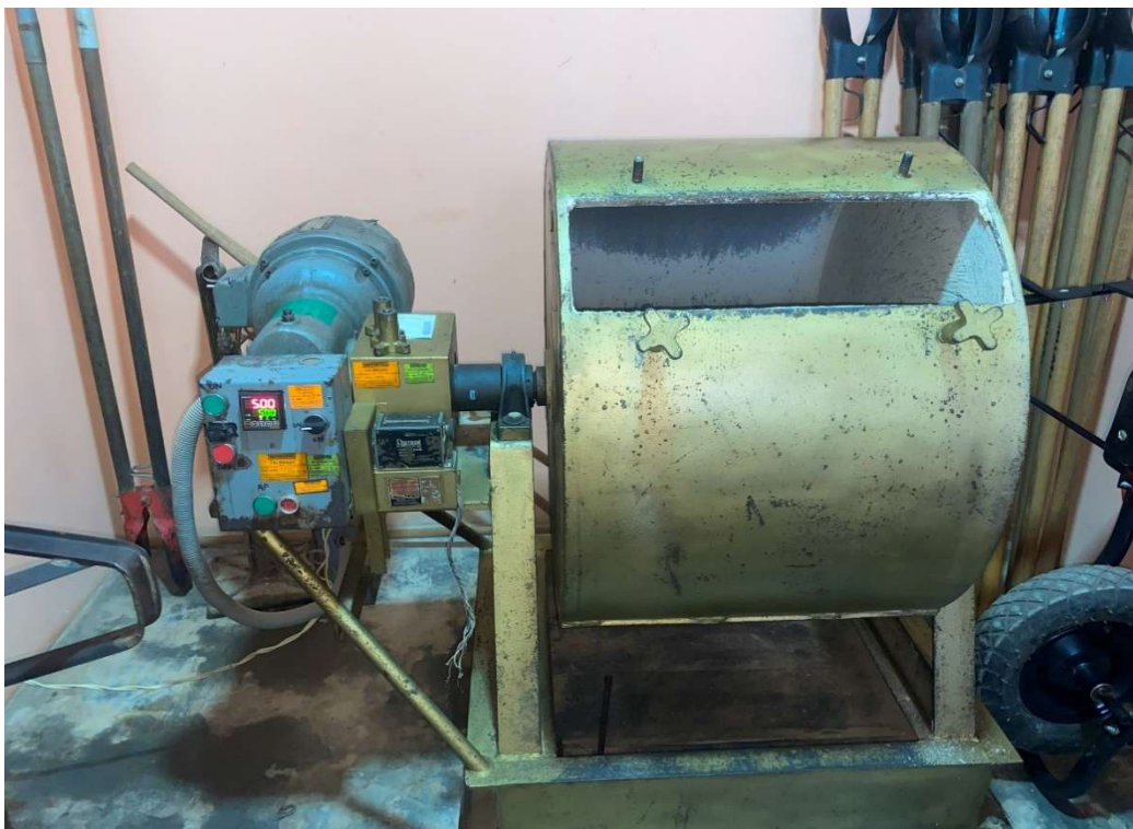
MAQUINA DE LOS ANGELES
