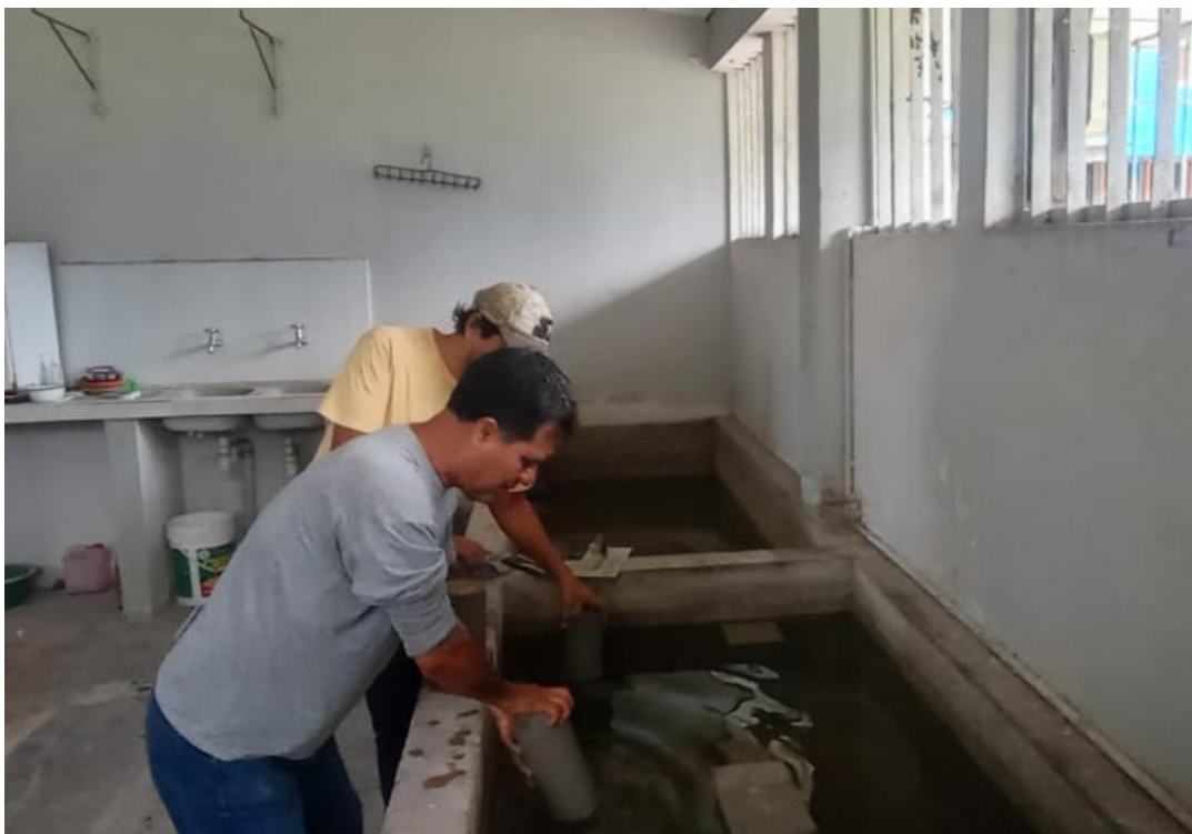
Curado de los testgos de concreto
