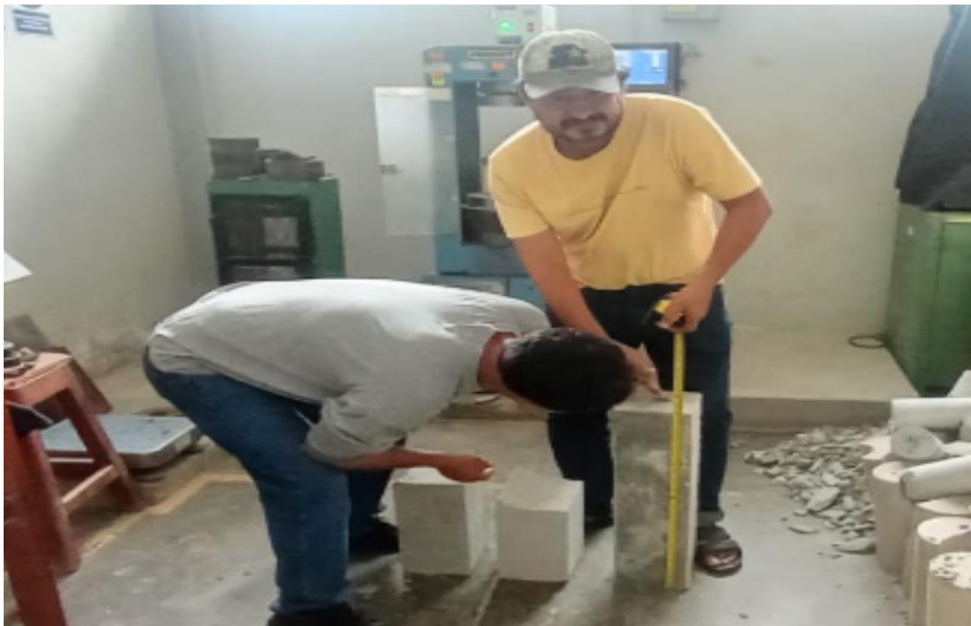
Verificación de testigos
