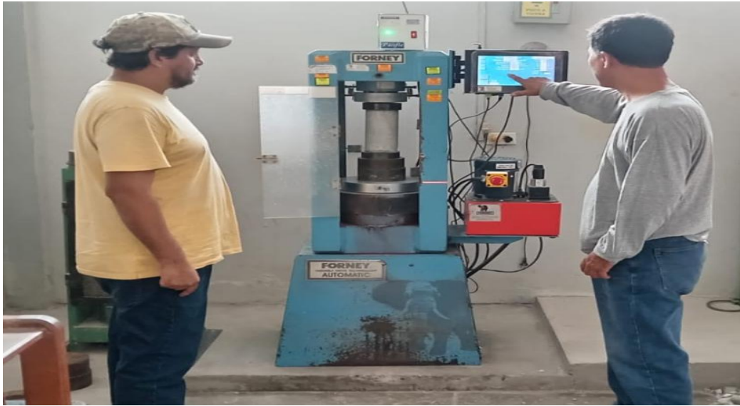
Resistencia a la compresión
