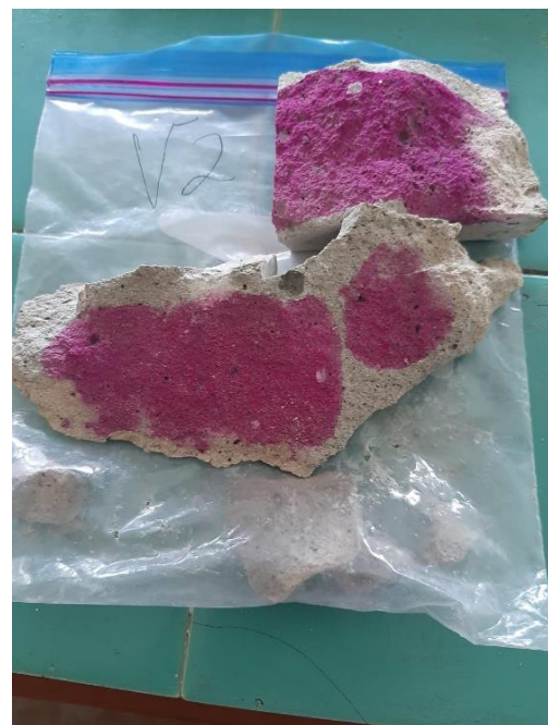
Prueba de carbonatación en vigas 1 y 2 (V1 y V2)
