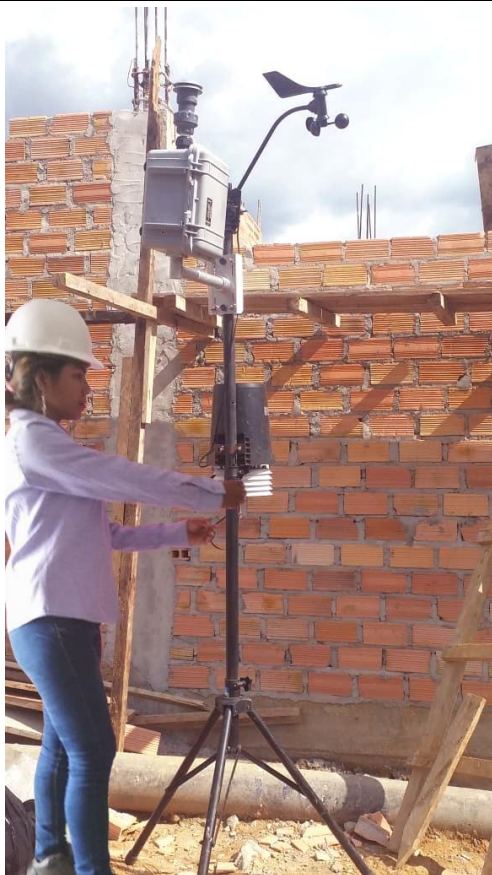
Colocación de Estación Meteorológica
