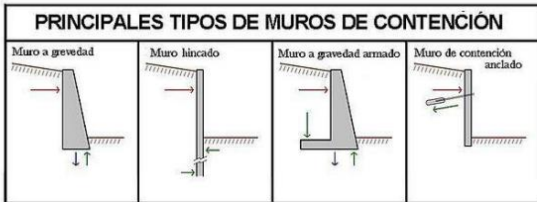
Ilustración 2: Principales tipos de muro de contención
