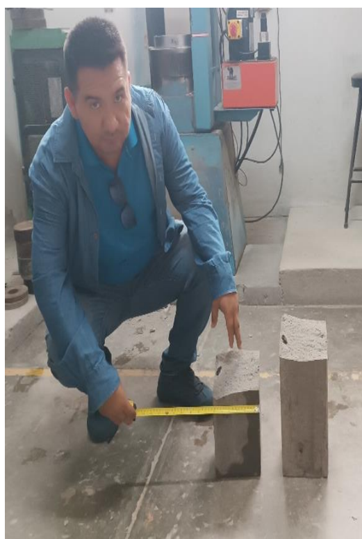
Ensayo de flexión de las vigas del concreto cemento arena.
