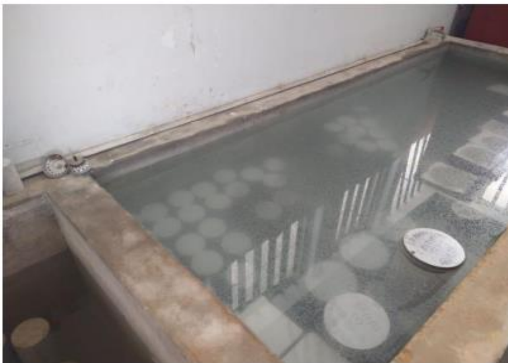
Curado de los testigos cilíndricos
