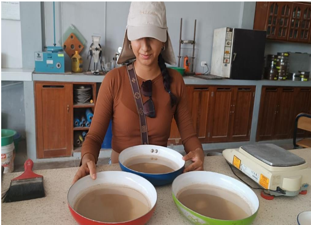
Ensayo de peso específico del agregado fino
