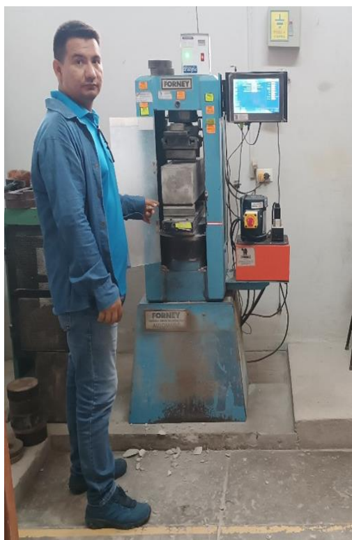
Ensayo de flexión de las vigas del concreto cemento arena.
