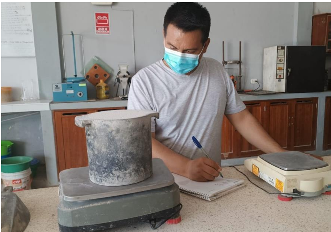
Ensayo de absorción del agregado fino
