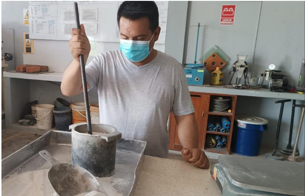
Ensayo del peso unitario compactado
