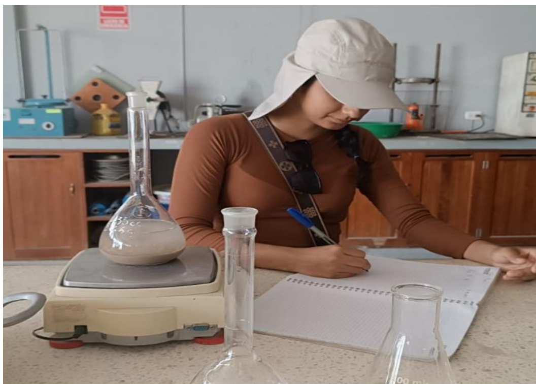
Ensayo de material que pasa por la malla N° 200
