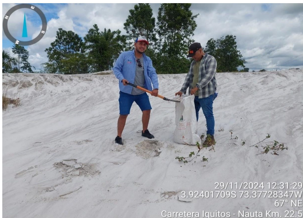
Imagen 6: Recolección del agregado fino (arena blanca – arena de cantera).
