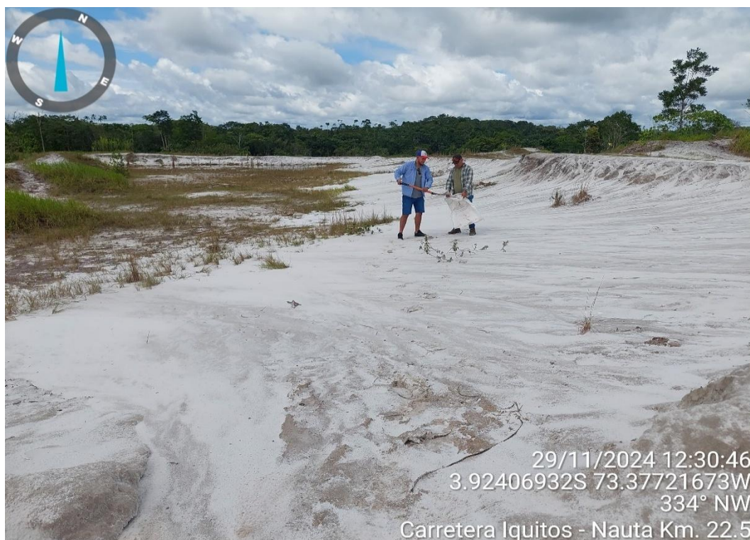
Imagen 7: Recolección del agregado fino (arena blanca – arena de cantera).
