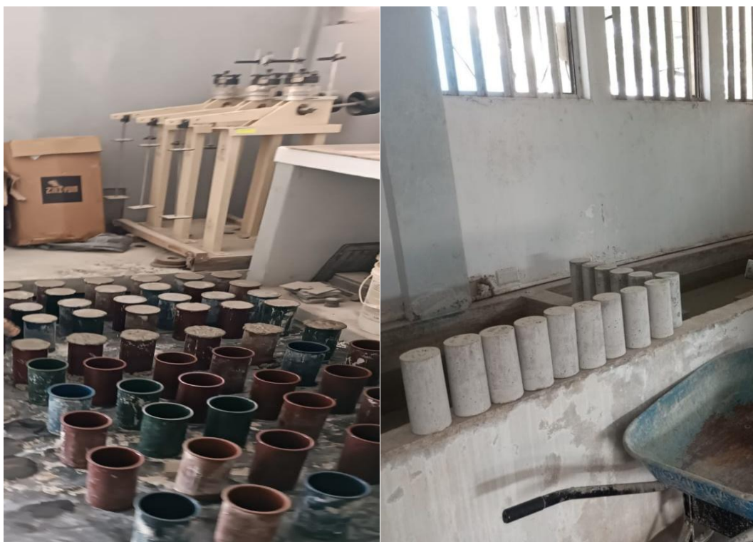
Imagen 11: Elaboración de las probetas del concreto (cemento – arena).
