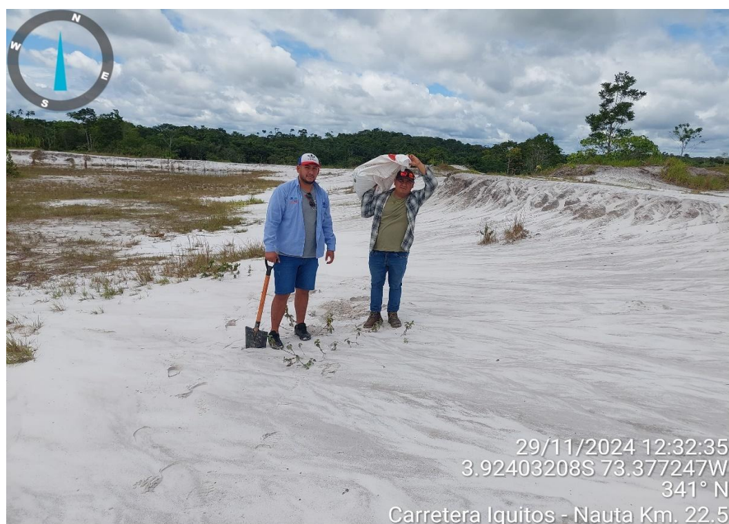
Imagen 8: Recolección del agregado fino (arena blanca – arena de cantera).
