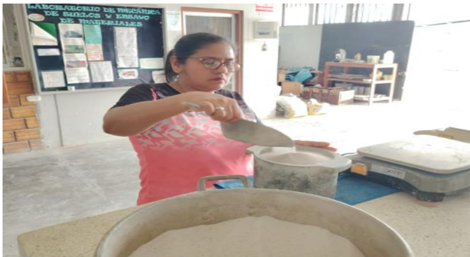
Ensayo de peso unitario suelto
