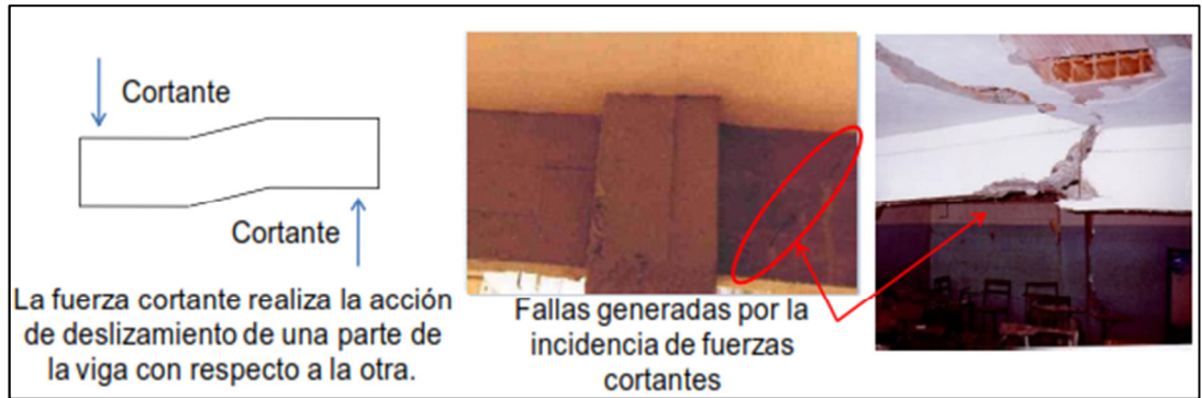
Gráfico N° 01: Cortante de elementos estructurales.
