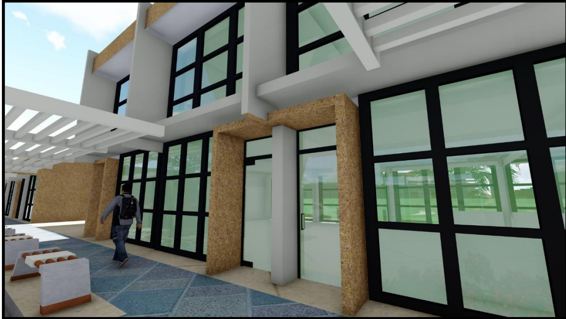
Figura 90. Aleros que disminuyen la radiación solar.
