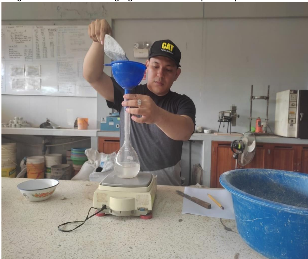
Imagen 2 Vertimiento del agregado en un recipiente y pesado del mismo.
