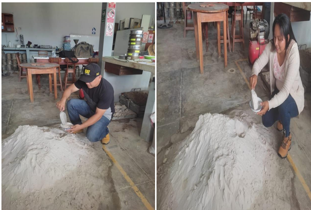
Imagen 1 Colocación del agregado en una tara para su pesado.
