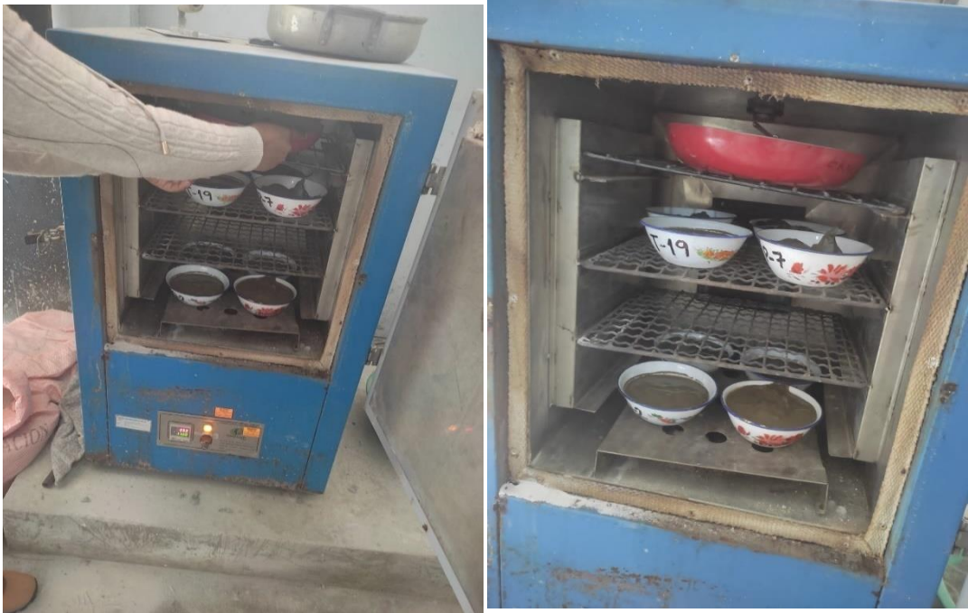
Imagen 3 Colocación de los agregados en la estufa para su secado.
