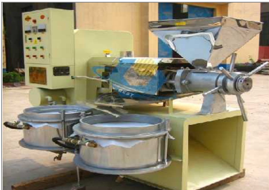
Figura N° 21. Máquina de extracción de aceite de coco virgen/ Máquina de aceite de prensa en frío/molino de aceite, 2019
