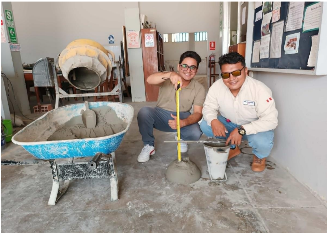
Imagen 2: Prueba del slump
