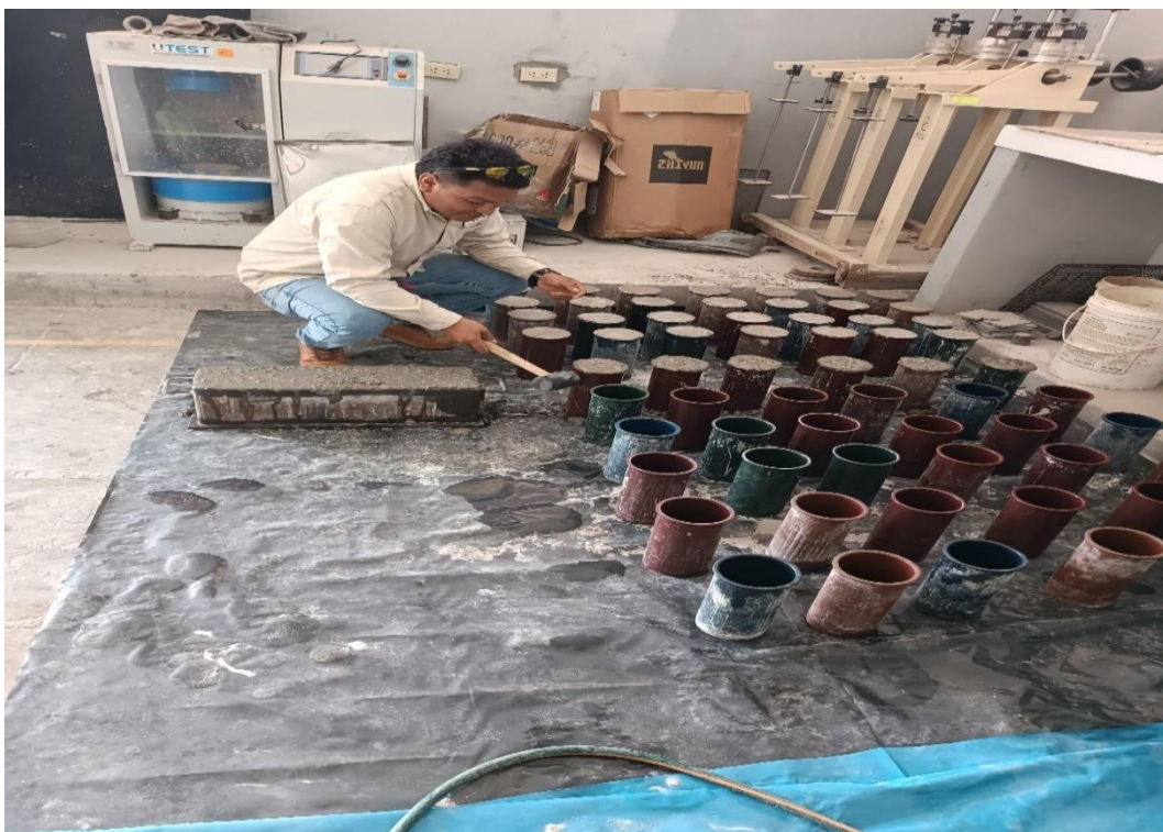
Imagen 4: Elaboración de las probetas de concreto (cemento – arena)
