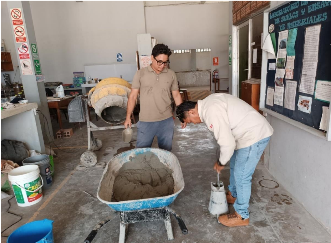
Imagen 1: colocacion del concreto en el cono de Abrams para la Prueba del slump.
