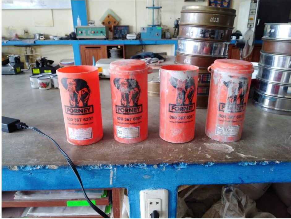
❖ Moldes de plástico de 4"x8" para ensayos en el laboratorio de Mecánica de Suelos y Ensayo de Materiales de la Universidad Científica del Perú.
