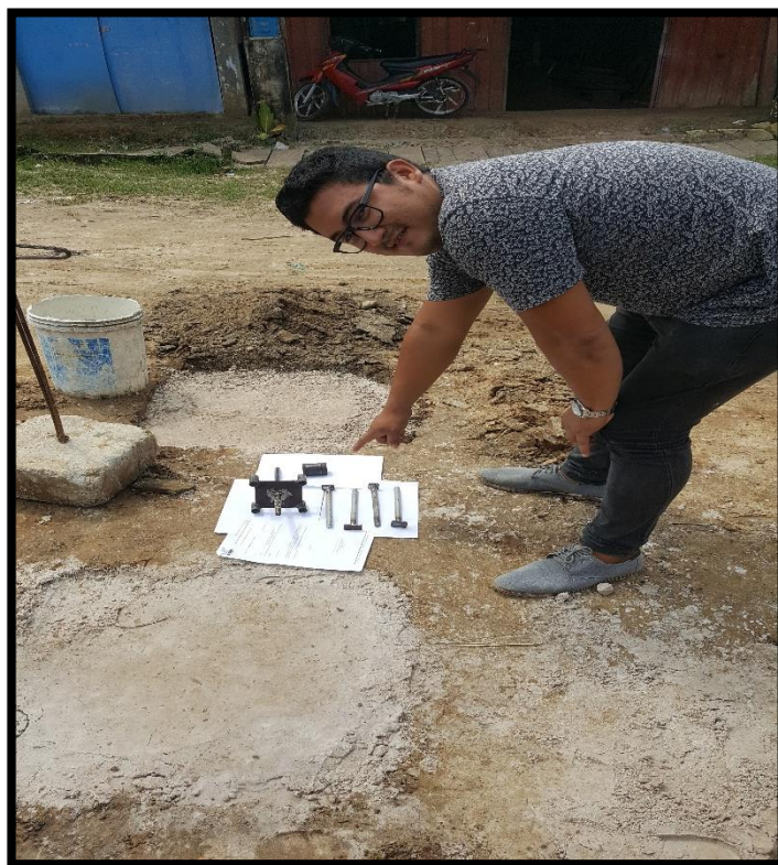
FOTO N° 27 SE MUESTRA EL EQUIPO Y LAS 2 ZANJAS PARA LAS PRUEBAS
