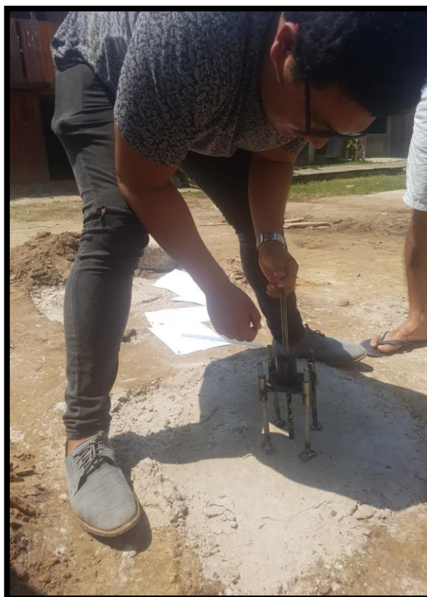
FOTO N° 31 PRUEBA 2 MARTILLO DE PENETRACION
