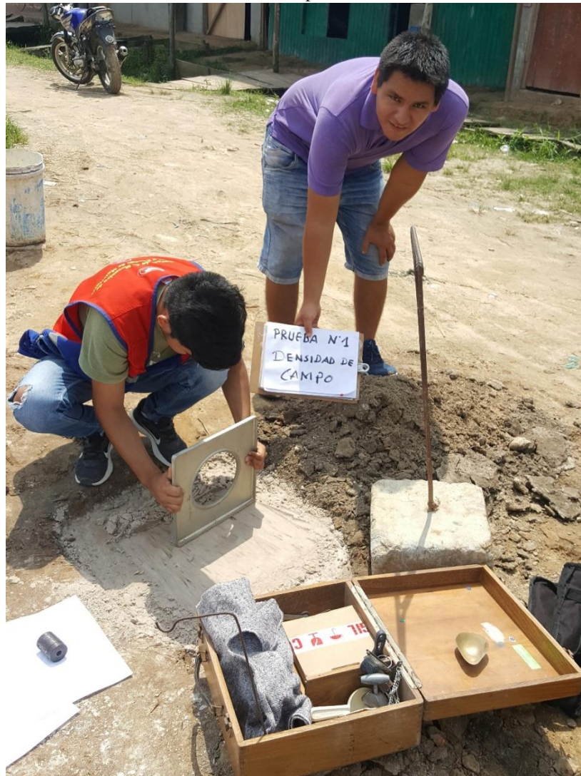
FOTO N° 11 Prueba de densidad de campo
