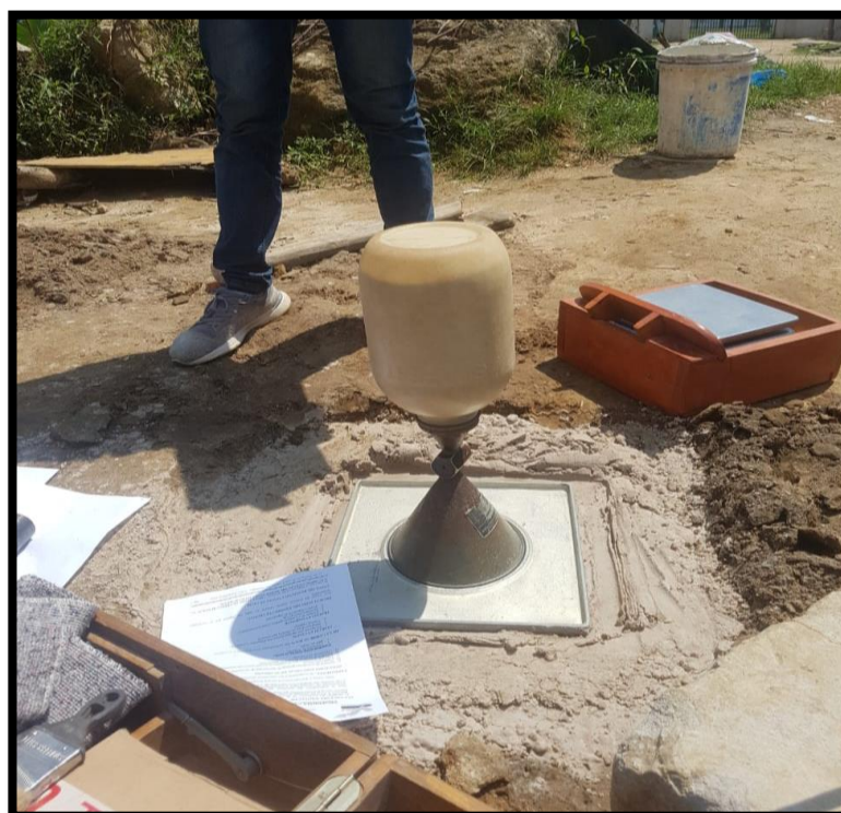
FOTO N° 29 PRUEBA DENSIDAD DE CAMPO
