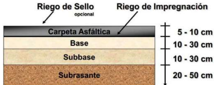
Ilustración 1: Sección Transversal Pavimento Flexible
