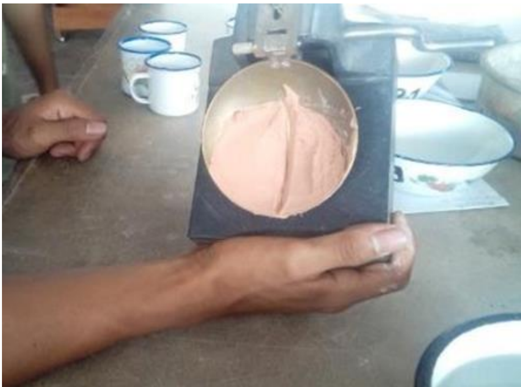
Imagen 4: Límite líquido en copa de Casagrande
