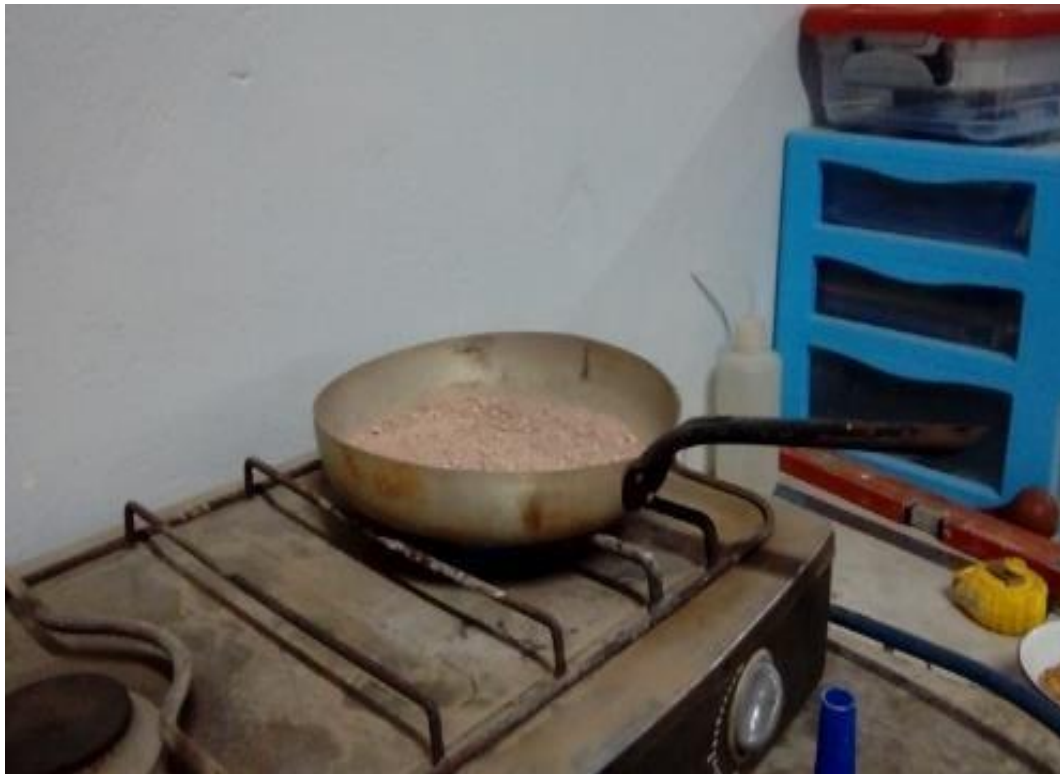
Imagen 3: Secado de muestras para Límites de Atterberg
