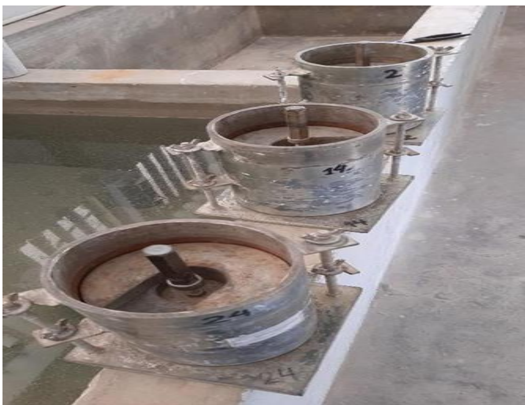
Imagen 10: Inmersión de moldes de CBR en material natural. Calicata 02.
