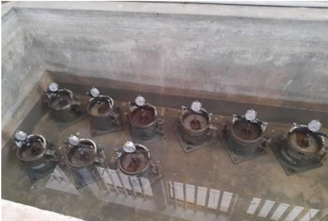
Imagen 12 : Moldes de muestra con diferentes % de cal hidratada en inmersión. Calicata 01.
