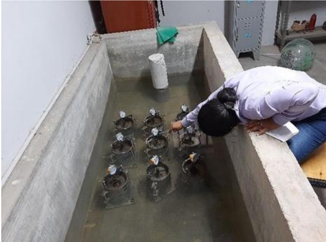
Imagen 15: Lectura de expansión en los moldes de CBR con diferentes % de cal viva. Calicata 02.
