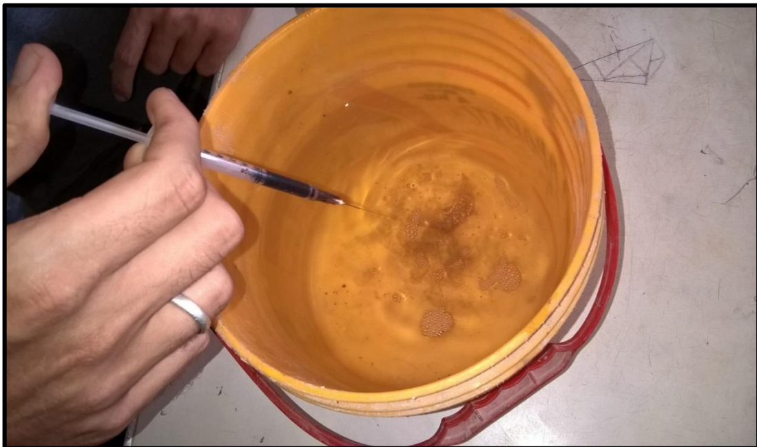
Foto N° 9. Mezcla de Aditivo PROES con agua.
