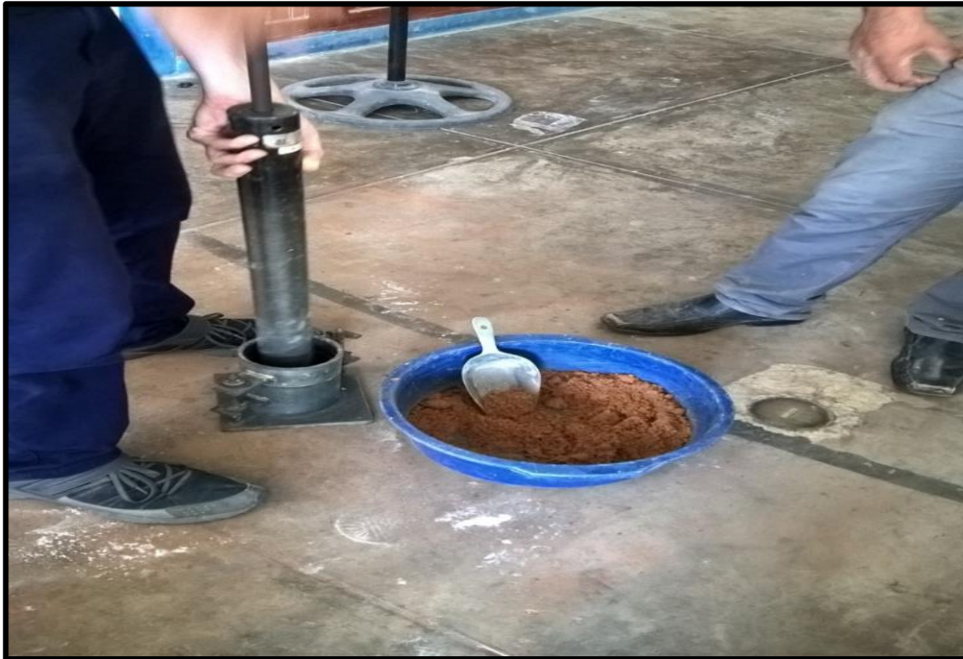
Foto N° 8. Ensayos de Próctor modificado.
