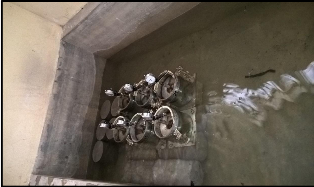
Foto N° 10. Muestras de ensayos sumergidos por 04 días en agua.
