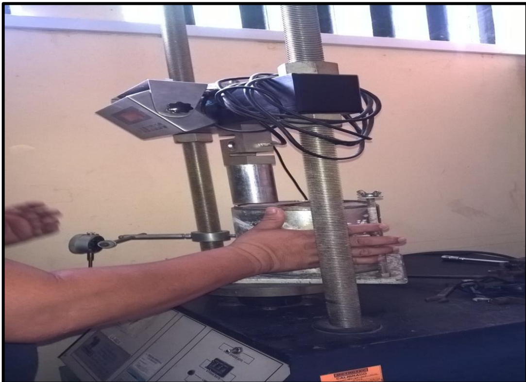
Foto N° 11. Prueba de carga CBR
