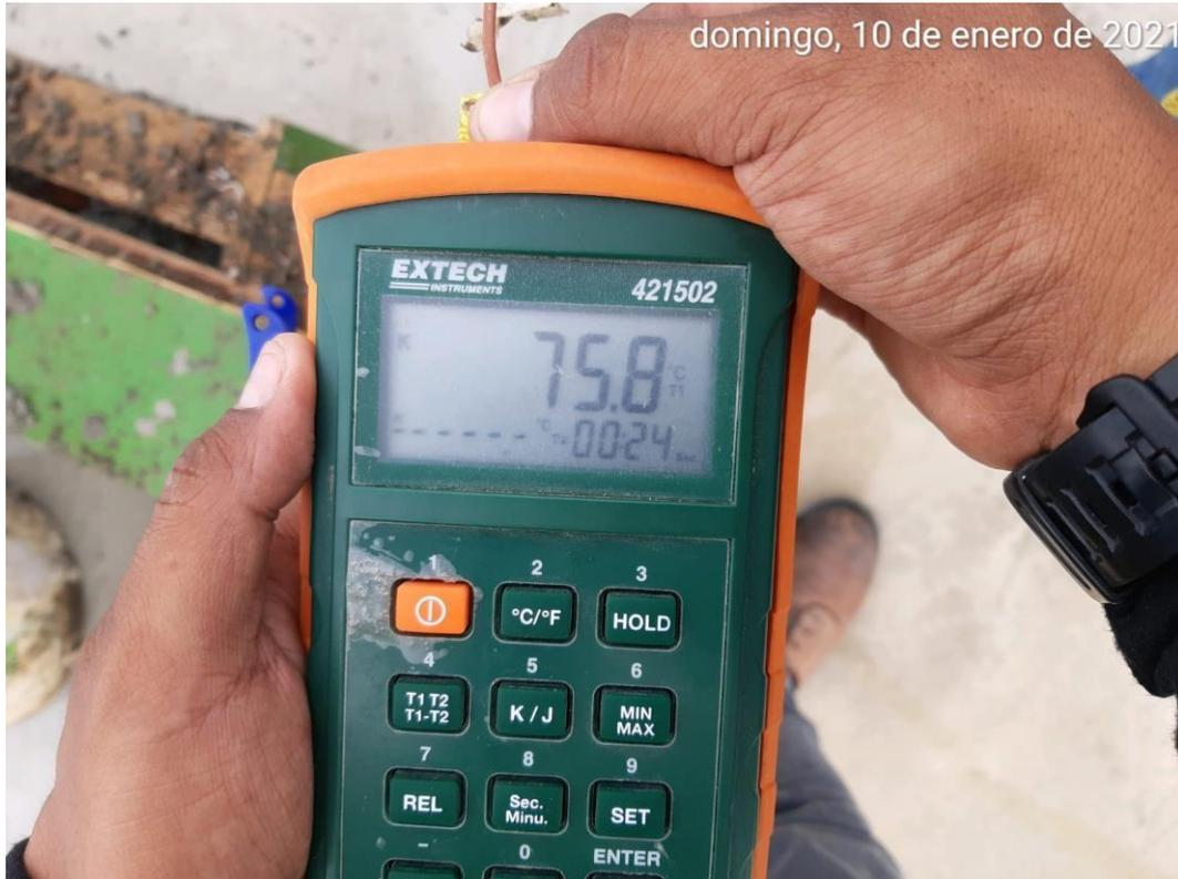
Aparato de visualización de temperatura (lector de temperatura)
